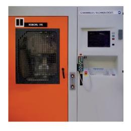
Erodieren per Elektroerosion schneidet mit Hilfe eines Metalldrahts (Elektrode) eine programmierte Kontur in ein Werkstück. Sie wird zur Herstellung von Matrizen, Formen und bestimmten Metallteilen genutzt. Auch für Teile, die komplizierte Konturen aufweisen, ist Drahterodieren oft eine kostengünstige Alternative.
